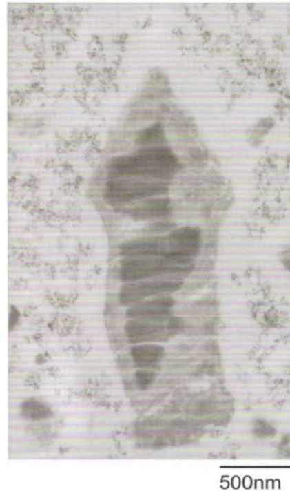
Fig. 3. Partícula de relleno tipo S-PRG (superficie pre-reativada con ionómero de vidrio), observada bajo el microscopio electrónico de transmisión (TEM). Nótese la periferia de la partícula. Tamaño original x 20,000.
